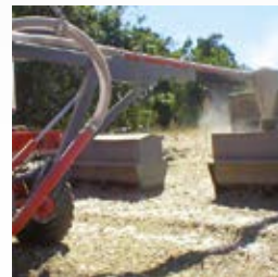
Distribution d'aliment ou de céréales 20 à 30 T/h (option bras télescopique)
